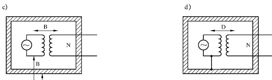
图 D.2 c) 和 d) 正常条件下不超过 6.3.2 限值的次级电路的可触及端子
