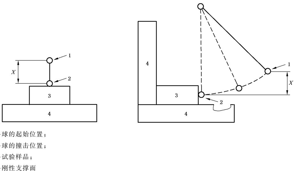
图 4 使用钢球的撞击试验
