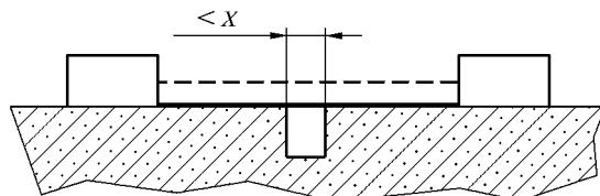
例 1 所测量的路径包含一条任意深度, 宽度小于  $X$ 、槽壁平行或收敛的沟槽。
