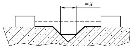
例 3 所测量的路径包含一条宽度大于  $X$  的 V 形沟槽。
