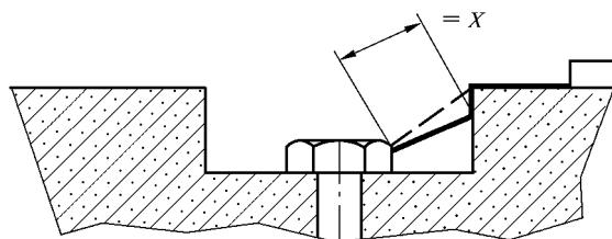
例 9 由于螺钉头与凹槽槽壁之间的空隙太窄,所以不必考虑该空隙。
