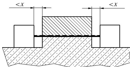
例 5 所测量的路径包含一条未粘合的接缝,该接缝的两侧各有一条宽度小于  $X$  的沟槽。
