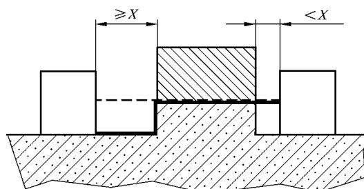
例 7 所测量的路径包含一条未粘合的接缝,该接缝的一侧有一条宽度小于  $X$  的沟槽,另一侧有一条宽度等于或大于  $X$  的沟槽。
