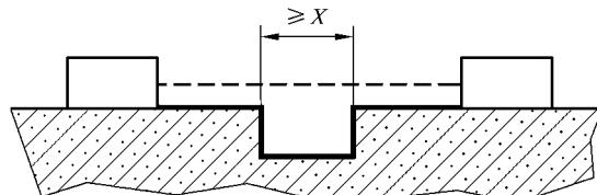
例 2 所测量的路径包含一条任意深度, 宽度等于或大于  $X$ 、槽壁平行的沟槽。
